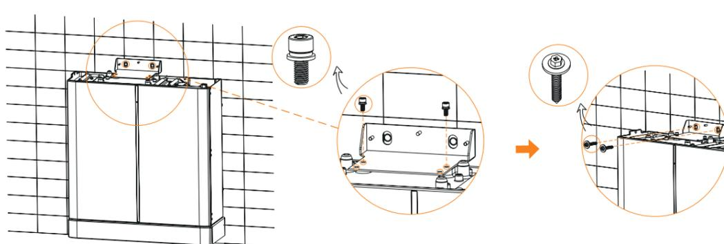
⑤ Paso 6: coloque el BMS en la parte superior del módulo de la batería, y asegure ambos lados izquierdo y derecho con tornillos M4 (2). Véase la imagen abajo.
