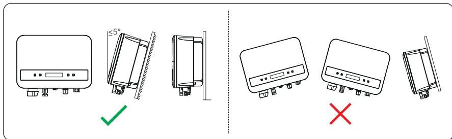
Installation Space / Installationsraum / Espace d'installation / Espacio de instalación / Espaço de instalação / Installatieruimte / Spazio di installazione / Przestrzeń instalacyjna / Instalační prostor / Installationsutrymme / Spaťu de instalare
