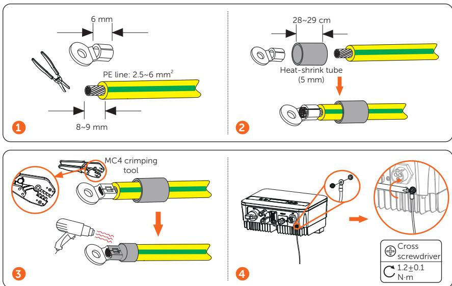
AC Side Connection / Wechselstrom-seitiger Anschluss / Connexion côté CA / Connexion lateral de CA / Ligação lateral CA / Aansluiting wisselspanningszijde / Collegamento lato CA / Połączenie po stronie AC / Boční připojení střídavého proudu / Anslutning på AC-sidan / Conexiune laterală c.a.
