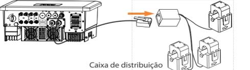
2) Num lado do cabo criado, é inserido o adaptador de linha de comunicação no inversor e um lado do terminal RJ45 é inserido na ligação do transformador de corrente.
