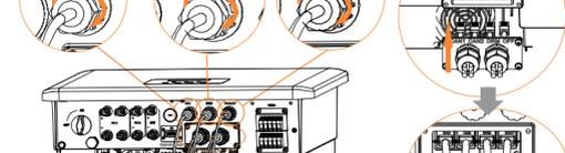
Passo 5. Insira a linha de comunicação (CAN/DRM/OFF) na porta correspondente, bloqueie a placa de cobertura e aperte a cabeça de fixação. Finalmente, encontre o COM, o METER e o BMS correspondentes e insira as portas correspondentes do cabo de comunicação inversor. E aperte bem o adaptador de comunicação.
