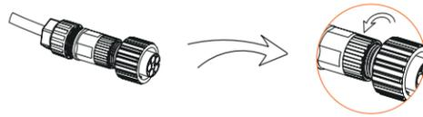
4. Apriete el tornillo de la carcasa trasera y la tuerca del cable.
